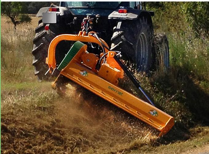
Desbrozadora de alta gama, multiuso polivalente, lateral y posterior, para trabajos en márgenes agrícolas, taludes, autovías, canales, carreteras y demás desbroce de obras públicas para tractores de 70 - 120 CV. Valvula de seguridad contra accidentes. Angulación +90° / -65°. Dos posiciones en puerta trasera. Rotor POLSER de 450 mm de diámetro con martillos de alto filo.
