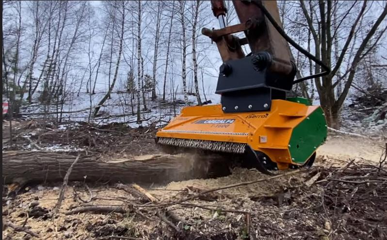
Cabezal adaptable a excavadoras entre 15 - 25 TM.
