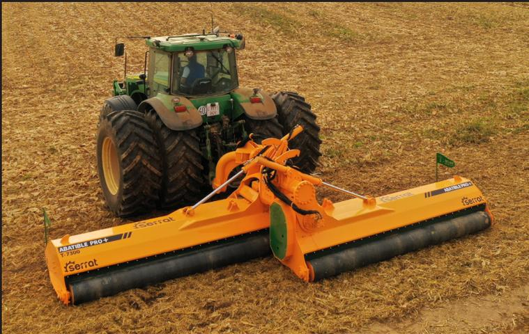
La Abatible Agrícola es una composición de dos máquinas estándar, superpuestas en el trabajo, unidas por un cuerpo central con sistema de auto plegado. La composición puede llegar a 6.30 m. El diseño de su transmisión por el interior deja los laterales limpios de obstáculos para la aproximación a las coberturas, etc.
