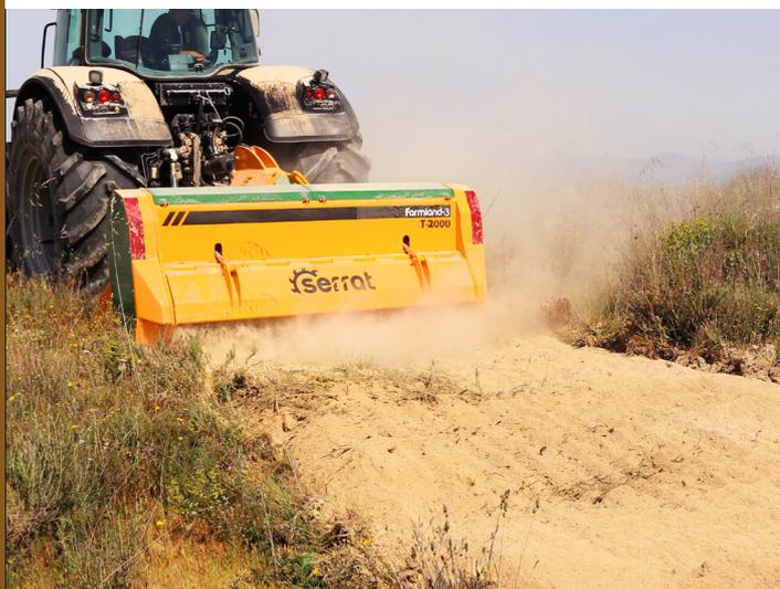
Máquina de preparación de suelo hasta una profundidad de 30 cm, para tractores entre 130 - 150 CV.
